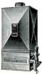
**Type 431. --** Fonctionne avec notre gazogène 403. Ce chauffe-bain à pression et à valve automatique ; peut être branché sur une canalisation sous pression de 1 à 6 kgs. Il débite 12 à 15 litres à la minute à 42°, l'eau étant prise à 10°. Le fonctionnement est identique à celui du chauffe-bain à gaz de ville, la veilleuse étant allumée au préalable, l'ouverture du robinet d'utilisation provoque l'allumage du brûleur, extinction de celui-ci à la fermeture du robinet. L'appareil est tout en
